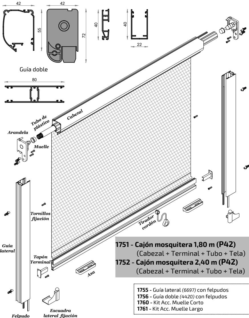
Cabezal    Testero cabezal    Terminal    Guía lateral
